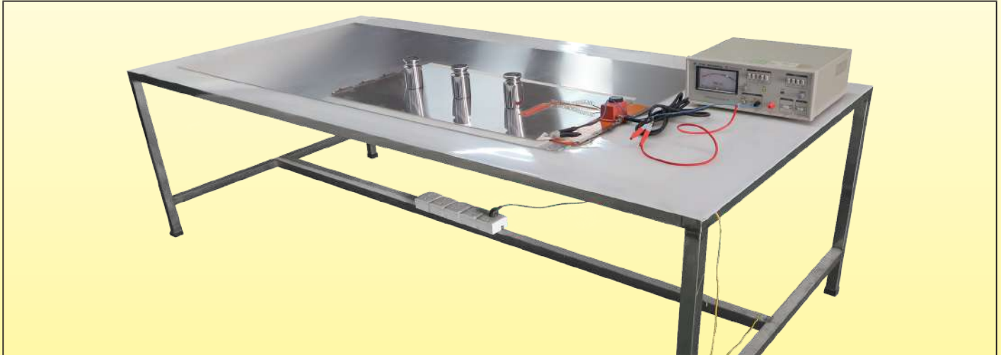
Dispositif de mesure de la résistance d'isolement. Les valeurs mesurées sont toujours supérieures à 0.1Gohm
