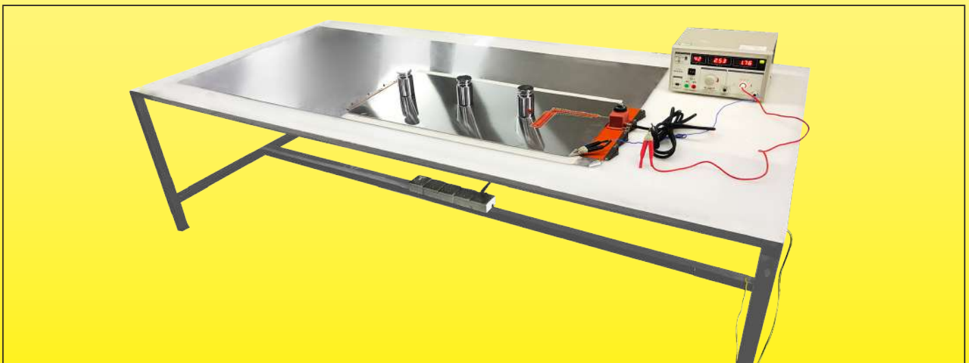
Equipement de mesure du courant de fuite total à froid
