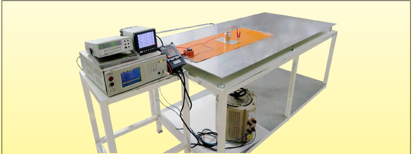
Dispositif d'essai de mesure du courant de fuite à chaud
